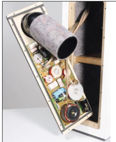
Docking-Station: Die Weiche wird quasi als Modul angedockt – inklusive Bassreflex-Rohr.
